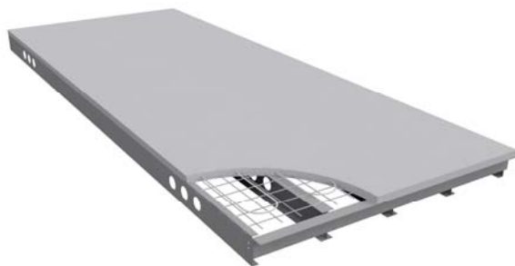
Principetekening Quantum-Deck ® vloersysteem
